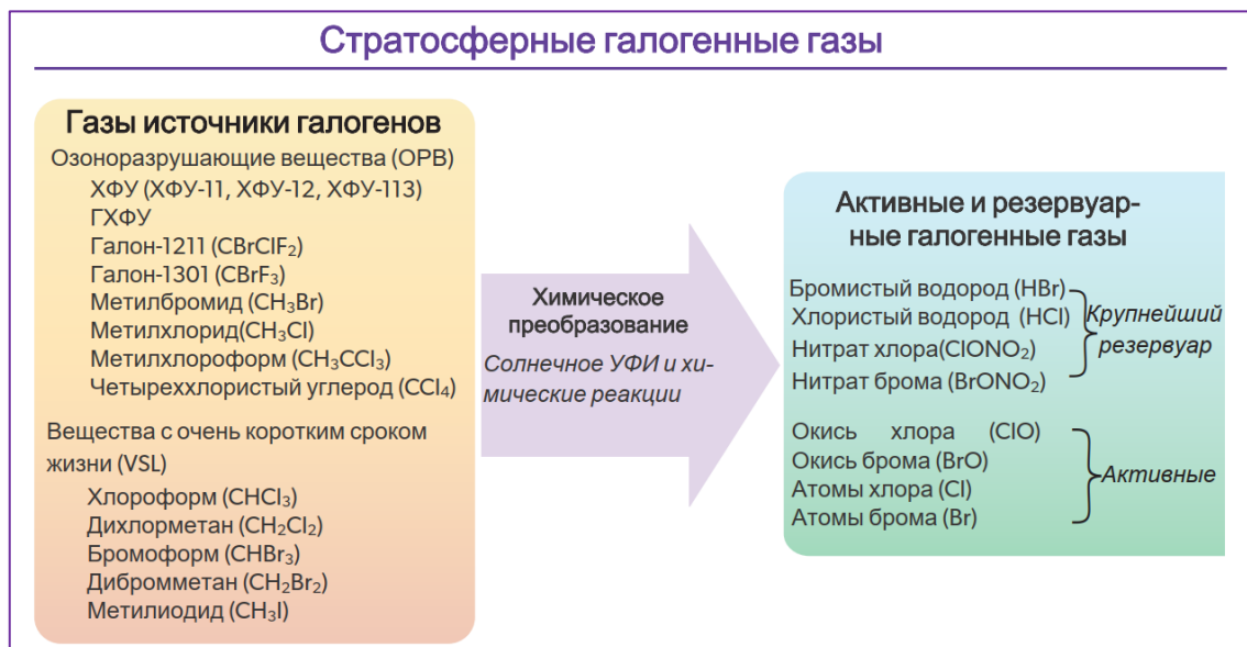
Рисунок В7-1. Преобразование исходных галогенных газов. Исходные галогенные газы, содержащие хлор и бром, химически преобразуются в реактивные и резервуарные галогенные газы, в основном в стратосфере. Преобразование требует солнечного ультрафиолетового излучения и нескольких химических реакций. Очень короткоживущие вещества частично теряются в тропосфере, поэтому меньшая часть этих газов достигает стратосферы по сравнению с другими исходными газами. Газы, полученные в результате этого химического преобразования, можно сгруппировать в резервуарные газы, которые не разрушают озон напрямую, и реактивные газы, которые участвуют в циклах разрушения озона (см. В8). Основным реактивным газом, \text{ClO} , образуется из резервуарных газов \text{HCl} и
