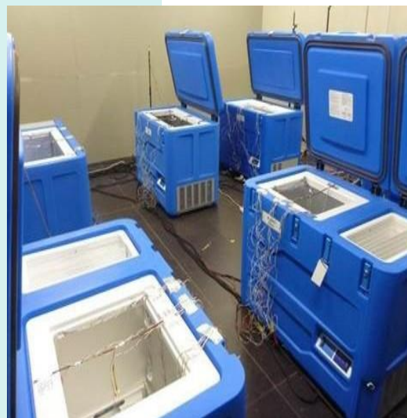
Рис. 11. Тестирование холодильников для вакцин по программе контроля качества ВОЗ ©Cemafröid
