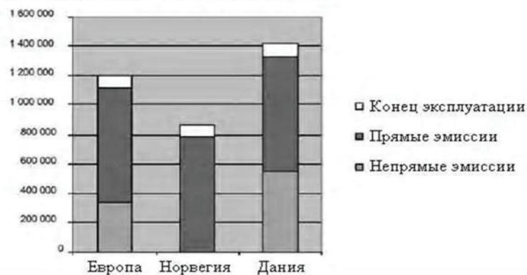
Рис. 4. Сравнение показателей LCCP в кг эквивалента диоксида углерода между R-744 (диоксид углерода) и ГФУ-134a для жарких климатов Нью Дели и Рима
