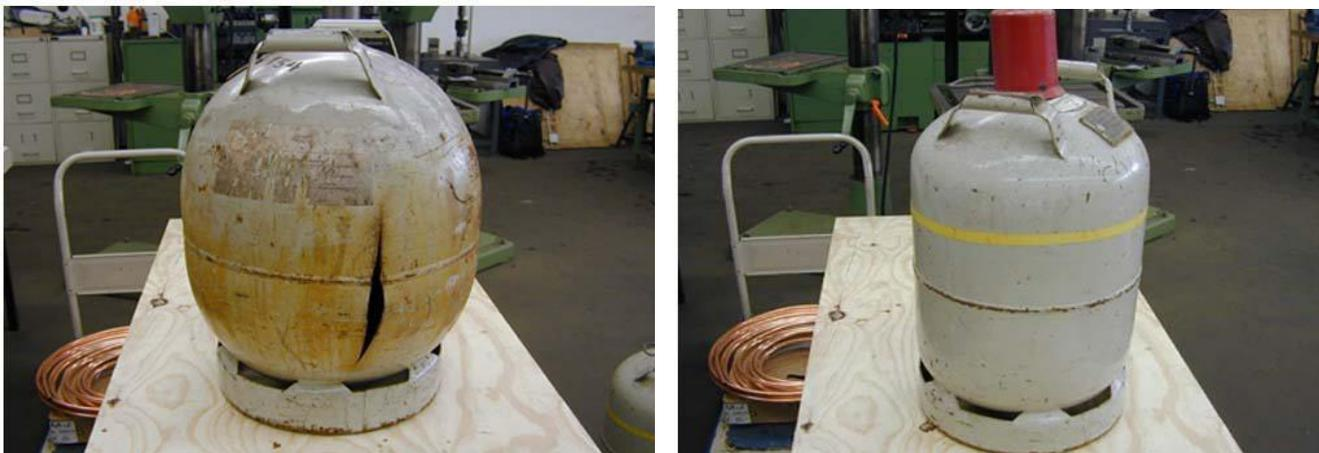
*Разрушение баллона под воздействием температуры*
