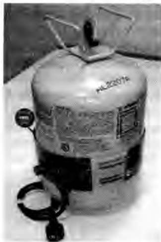
Рис. 5.30. Заправочный баллон с электронагревателем
