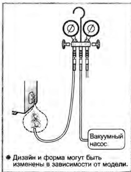
Рис. ПЗ.17. Подсоединение заправочного шланга
