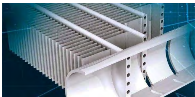
Рисунок 10. Фрагмент устройства микроканального теплообменника
