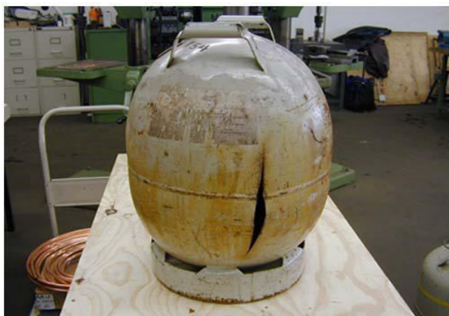
Разрушение баллона под воздействием температуры
