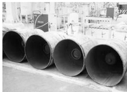
Вид малых баллонов с ГФУ -134a после удаления хладагента ХФУ-12 и вскрытия основных контейнеров
