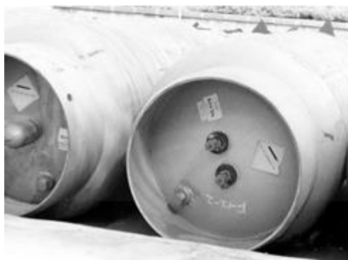
Вентили доступа на малых баллонах с ГФУ-134a
