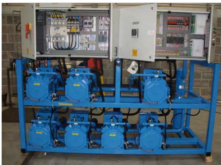
Автономные системы заводского изготовления отличаются небольшой заправкой хладагента и низкой интенсивностью утечек.
