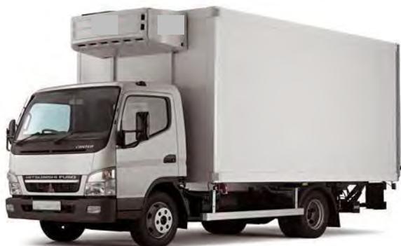
*Малотоннажный авторефрижератор, компрессор расположен рядом с основным двигателем транспортного средства*
