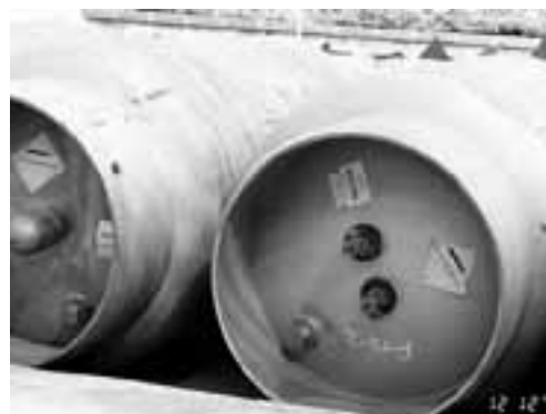
Фото 5-4. Вентили доступа на малых баллонах с ГФУ-134a.
