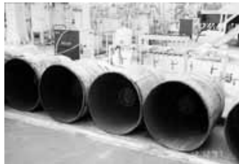
Фото 5-2. Вид малых баллонов с ГФУ -134a после удаления хладагента ХФУ-12 и вскрытия основных контейнеров.
