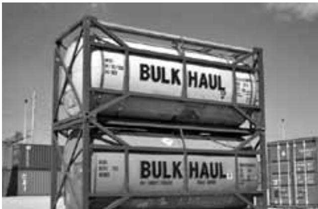
Фото 6-15. Уложенные штабелем контейнеры ISO.
