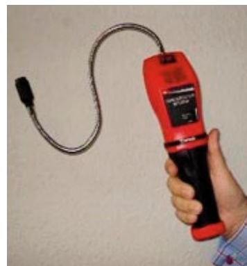
Рисунок 3 – Электронный течеискатель, совместимый с огнеопасными хладагентами.
