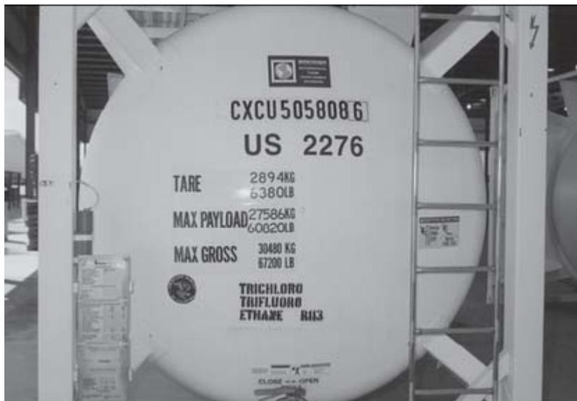
Фото 17 - Передняя часть цистерны ИСО (см. таблицу с примерами маркировок ИСО на цистернах)
