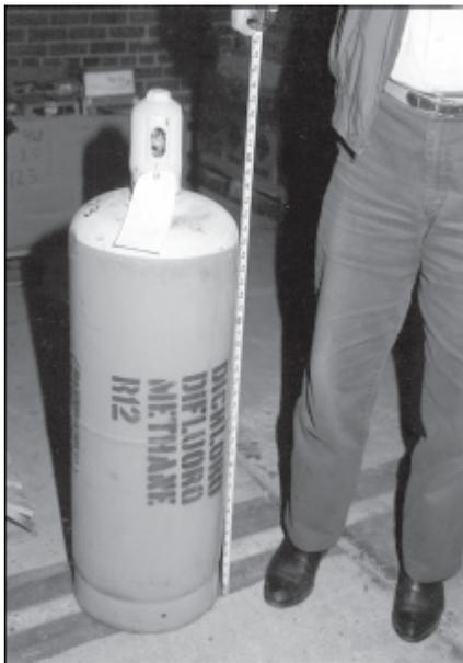
Фото 9 – Пример цилиндра с ХФУ-12, дихлордифторметан
