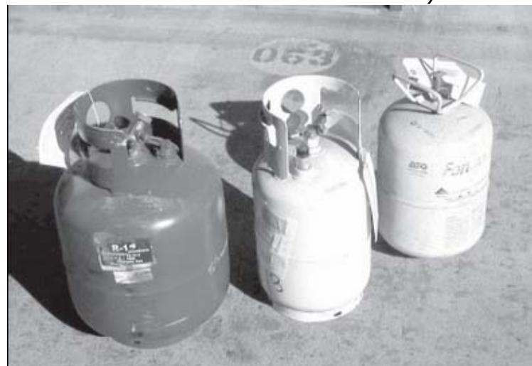
Фото 12 – 50-и 30-фунтовые цилиндры повторного использования; 30-фунтовый цилиндр повторного использования
