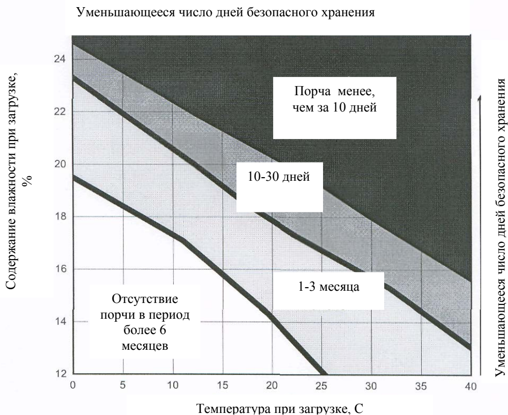
Рис. 7. График времени хранения пшеницы, указывающий зоны, в которых порча проявляется менее, чем за 10 дней, в период 10-30 дней, 1-3 месяцев, а также зону, в которой отсутствует порча на протяжении, по крайней мере, 6 месяцев.
