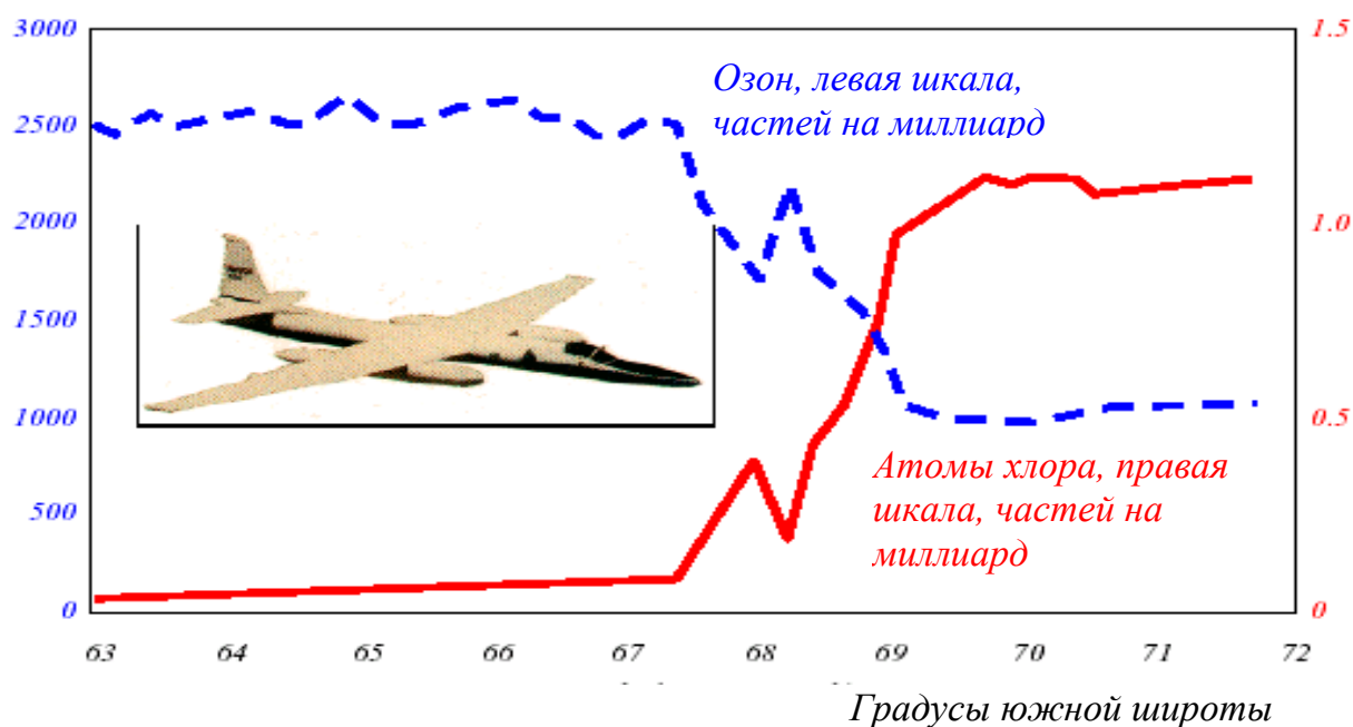
Рис. 4. Измерение содержания озона и атомов хлора с самолета в районе антарктической озоновой дыры
